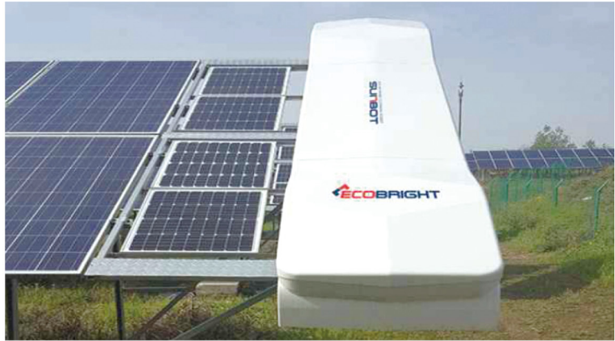
에코브라이트코리아의 태양광발전소 고정식 자동청소 로봇
